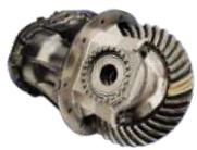
Desmontagem, avaliação da carcaça, avaliação dos componentes, limpeza e higienização, substituição dos componentes, montagem, lubrificação, pintura, teste e devolução ao cliente.
